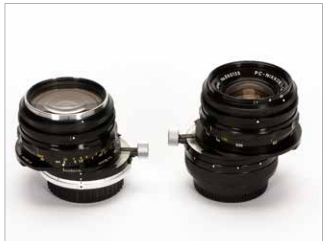
PC-NIKKOR 35mm f/3,5 (1962) – mittels eine Schraube konnte das Frontlinsenpaar um 11mm seitlich verstellt und das Ganze in 30° Schritten gedreht werden. Damit ließen sich stürzende Linien zumindest bedingt vermeiden. Beim PC-NIKKOR 35mm f/2,8 (1968) – auch hier die gleiche Anwendung, nur ist das Objektiv etwas lichtstärker. Da die Blendeneinstellung in vorderen Bereich des Objektivs verbaut ist, erfolgte keine Übertragung der Blendeneinstellung auf den Belichtungsmesser der Kamera.
