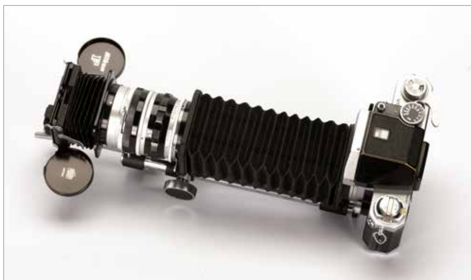
Nikon F mit Photomic FTN, Balgengerät Bellows II (1959) und Diakopiervorsatz (Slide Copying Adapter, 1959). Zur Aufnahme von Dias oder Filmen ist hier ein 2,8cm f/3,5 NIKKOR-H Auto Weitwinkelobjektiv in Retrostellung mittels des Umkehrings BR-2 und des Filteranschlussrings BR-3 eingesetzt.
