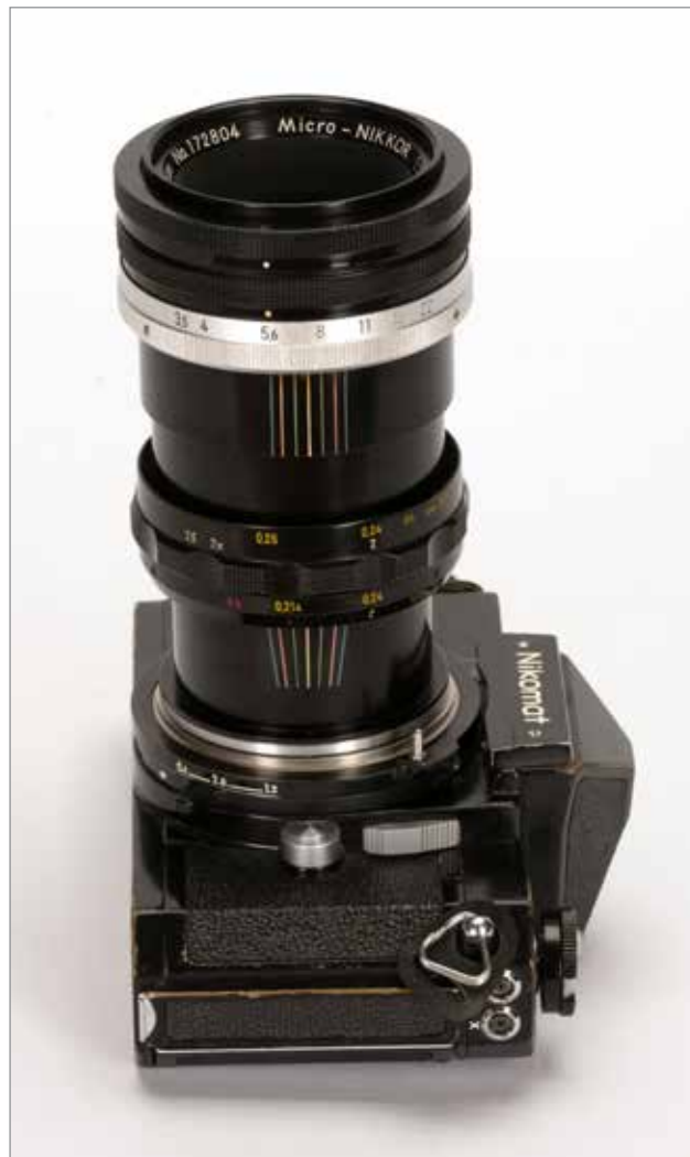
Micro-NIKKOR 5,5cm f/3,5 (1961), Objektiv für Makroaufnahmen, Einstellung bis Maßstab 1:1 ohne Zwischenring aber auch ohne Übertragung der Blendeneinstellung an den Belichtungsmesser der Kamera. Hier der zweite Typ des Objektivs, angesetzt an eine Nikonmat Kamera.
