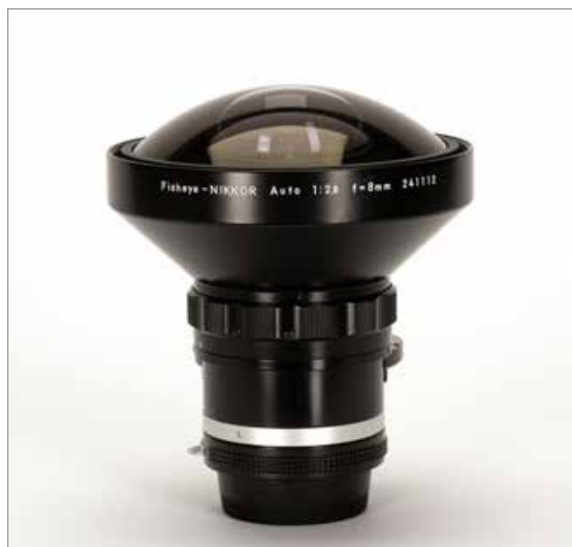
Fisheye-NIKKOR 8mm f/2,8 (1970) - hier konnte das Sucherbild der Kamera direkt zur Motivauswahl eingesehen werden. Zudem wurde die Blendeneinstellung des Objektivs über eine Gabel (Blendenmitnehmer) auf den Belichtungsmesser der Kamera übertragen. Auf dem Film abgebildet wurde ein kreisrundes Bild (180° Bildwinkel) mit einem Durchmesser von 23mm.
