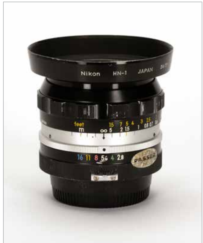
NIKKOR-N Auto 24mm f/2,8 (1967). Dieses Objektiv weist erstmals sogenannte „Floating Elements“ auf. Diese bewirken eine bessere Schärfe in Nahbereich.
