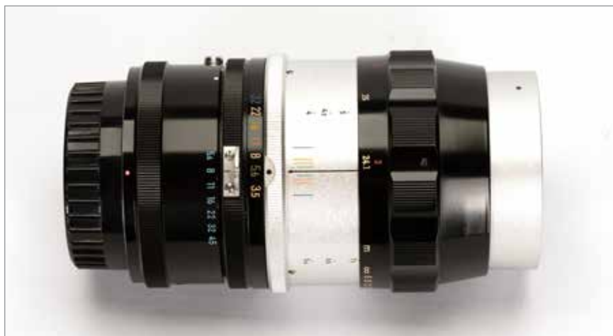
Micro-NIKKOR Auto 55mm f/3,5 (1963), Nachfolgemodell des 5,5cm f/3,5 Micro-NIKKOR Objektivs, Einstellung bis Maßstab 1:2, mit angesetztem Zwischenring bis 1:1. Dieses Objektiv ist mit einem Blendenmitnehmer ausgestattet, der angesetzte Zwischenring M allerdings nicht.
