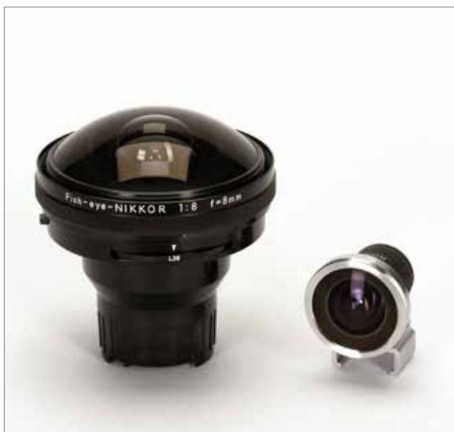
Fisheye-NIKKOR 8mm f/8 (1962) mit Fisheye-Sucher, da der Spiegel der Kamera zum Aufsetzen und Fotografieren hochgeklappt werden musste. Auf dem Film abgebildet wurde ein kreisrundes Bild (180° Bildwinkel) mit einem Durchmesser von 24mm.
