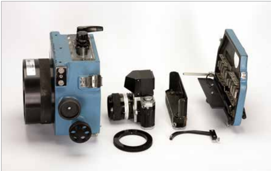
Oceanic Hydro 35 (1972) Unterwassergehäuse mit Nikon F, Sportsucher, Motorantrieb F 36 und Micro-Nikkor 55mm f/3,5 Objektiv. Der Motor wurde mit 8 AA Zellen betrieben. Das Zahnrad dient zur Übertragung der Entfernungseinstellung und der Hebel zur Übertragung der Blendeneinstellung.
