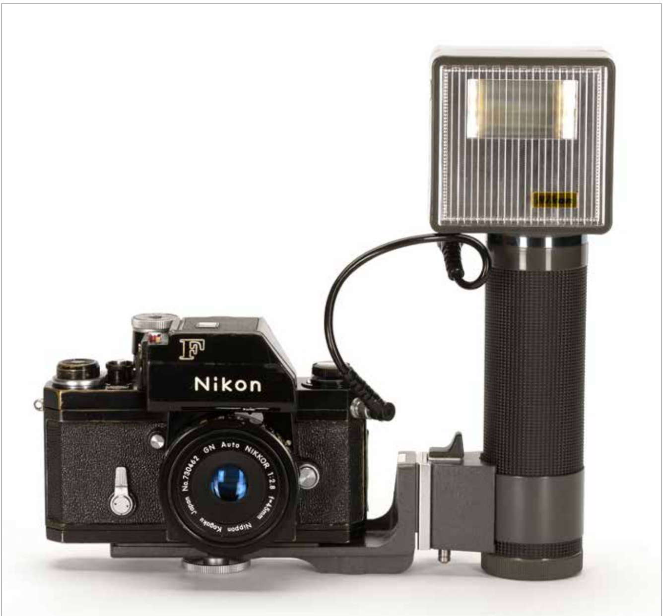
Nikon mit Photomic FTN, angesetztem GN-NIKKOR Auto 45mm f/2,8 (1968) und Blitzgerät SB-1 (1968). Am Objektiv konnte die Leitzahl und die Empfindlichkeit des verwendeten Filmmaterials eingestellt und mit der Entfernungseinstellung verriegelt werden. Entsprechend der eingestellten Entfernung wurde das Objektiv (in dem zulässigen Bereich) damit automatisch abgeblendet. Das SB-1 verfügt über einen aufladbaren Akku, dennoch konnten sowohl verschiedene Batterieteile als auch zwei Ring-Bitze angeschlossen werden.
