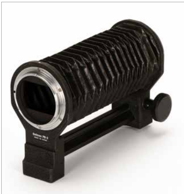
Nikon Balgengerät PB-3 (1966). Leichtes und preisgünstiges Balgengerät, an dem allerdings auch nur leichte Objektive verwendet werden konnten, denn sonderlich stabil waren die Standarten nicht (ohne Möglichkeit ein Diakopiergerät anzusetzen).
