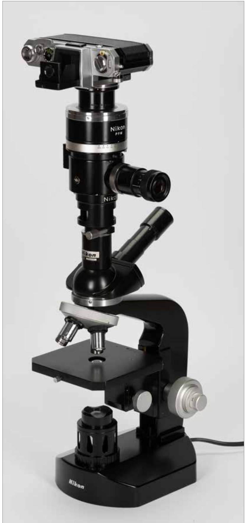
Nikon Microscope S (1956) mit Mono-Mono Tubus, 2 Okularen und 4 Objektiven. Zum vibrationsfreien Fotografieren wurde ein Nikon Microflex PFM (2. Typ, 1965) mit Verschluss mit einer Nikon F mit Lichtschacht aufgesetzt.
